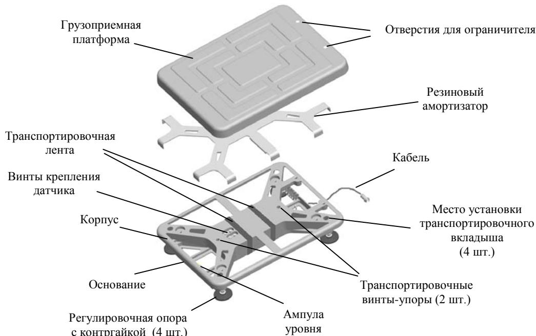
Рис. 4.1 – Модуль взвешивающий TB-S\_
